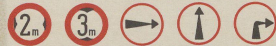
Verbot für Fahrzeuge über 2 m Breite Verbot für Fahrzeuge über 3 m Höhe Gebotene Fahrtrichtung: rechts Fahrtrichtung: geradeaus Rechts abbiegen
