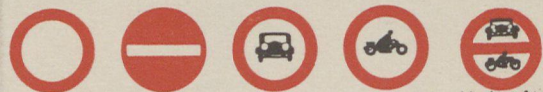
Verbot für Fahrzeuge aller Art Verbot einer Fahrtrichtung od. Einfahrt Verbot für Kraftwagen Verbot für Krafträder Verbot für alle Kraftfahrzeuge
